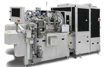
电子元件用溅射镀膜设备
