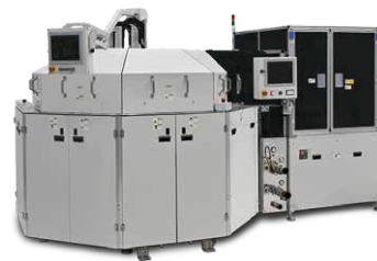
电子元件用溅射镀膜设备
